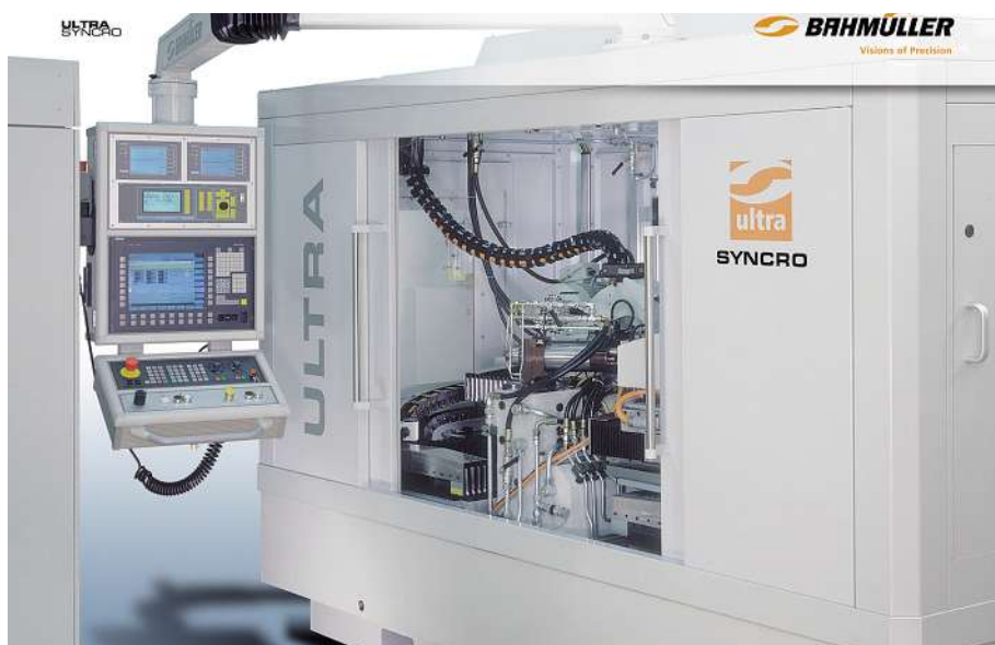
Bild 1: Ultra Syncro: Zwei Werkzeuge sind synchron an einem Werkstück auf einer Arbeitsstation im Eingriff.
