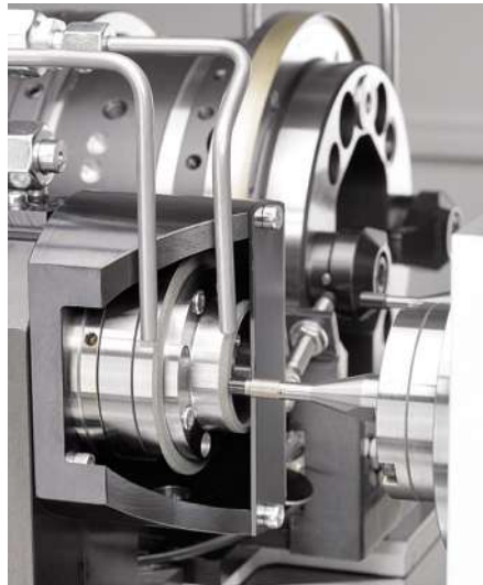
Bild 2: Schleifsituation: Innenschleifwerkzeug mit Abrichteinheit und Spannutter.
